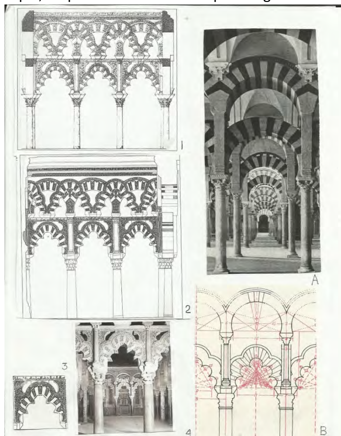
Figura 20-2. El entramado lobulado del muro sur, cara exterior, Capilla de Villaviciosa.
