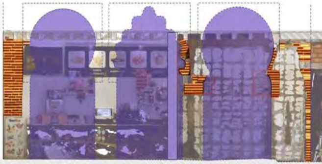
Figura 13. Restitución de supuesta arquería de tres arcos (1) inspirada en restos aislados de arcos de herradura y lobulados de un edificio toledano 153 . Sería arquería de pórtico de patio de casa importante del siglo XI o XII o los tres arcos que desde el patio de una mezquita daban entrada al haram, como ejemplo los tres arcos (3) de la mezquita aljama de Niebla (Huelva) 154 .
