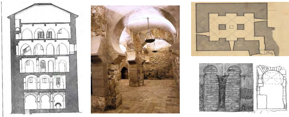
Figura 17, 1, Torre del Trobador de la Aljafería, sección según Iñiguez Almech 66 , árabe los dos pisos primeros con arcos de herradura aplastados o de tres radios (2), planta árabe de seis espacios (3) y otros ejemplos de arcos de herradura de tres radios: ventana de la mezquita aljama de Tudela y arco de la alcazaba de Málaga (4) (5) 67 .
