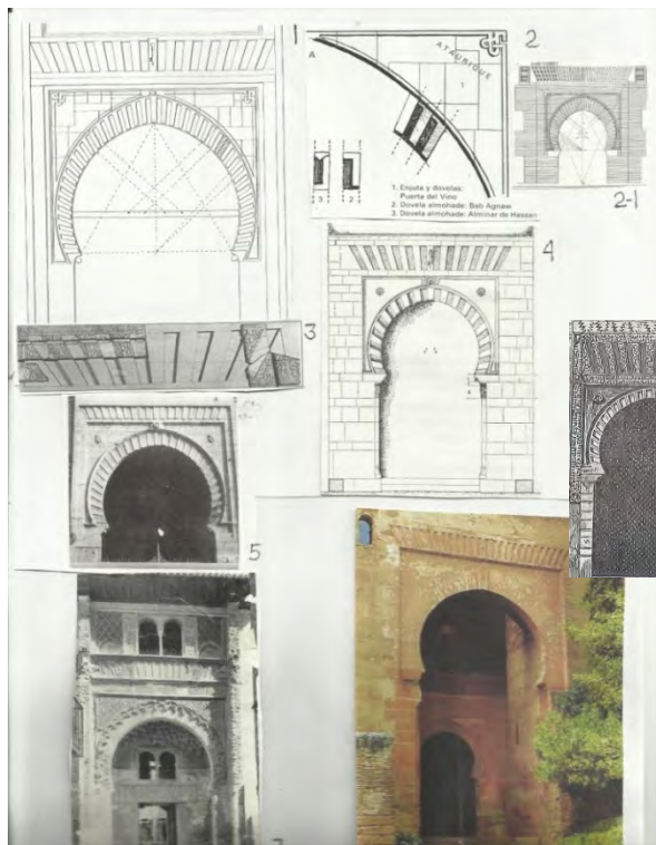
Figura 38. Puertas Granadinas con arco y dintel de dovelas entrantes y salientes.
